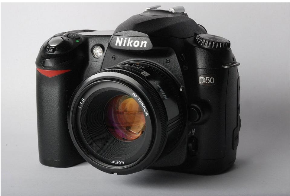
Il corpo era più piccolo e leggero, con un'interfaccia semplificata, pensata per chi proveniva dalle compatte digitali ma con il suo sensore CCD da 6,1 megapixel e l'AF a 5 punti offriva comunque prestazioni di buon livello per l'epoca.
